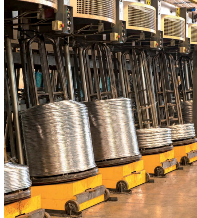
Linea automatica per la zincatura a caldo per fili metallici da 1,20 a 6,50 mm di diametro
