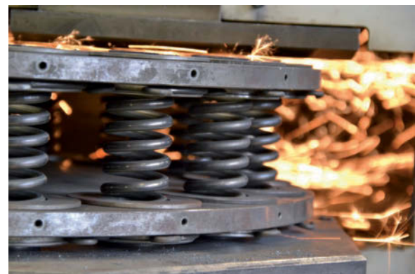
Molle a compressione sottoposte a molatura.
