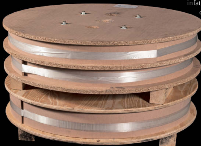
Bandella prodotta attraverso la laminazione a freddo ed il successivo incollaggio a caldo dei fili metallici.
